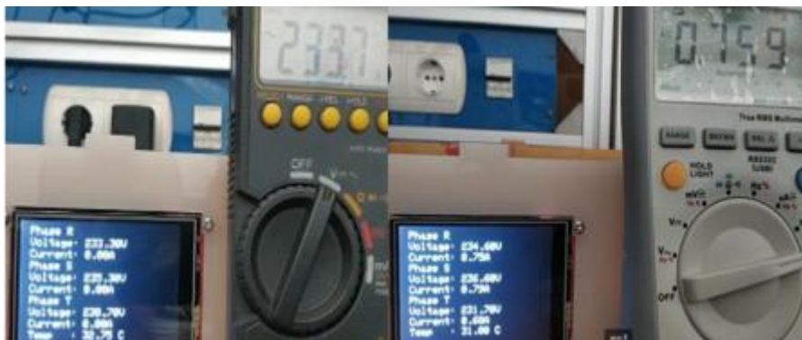
Gambar 4: Pengujian Sensor PZEM004T dengan Alat Ukur
