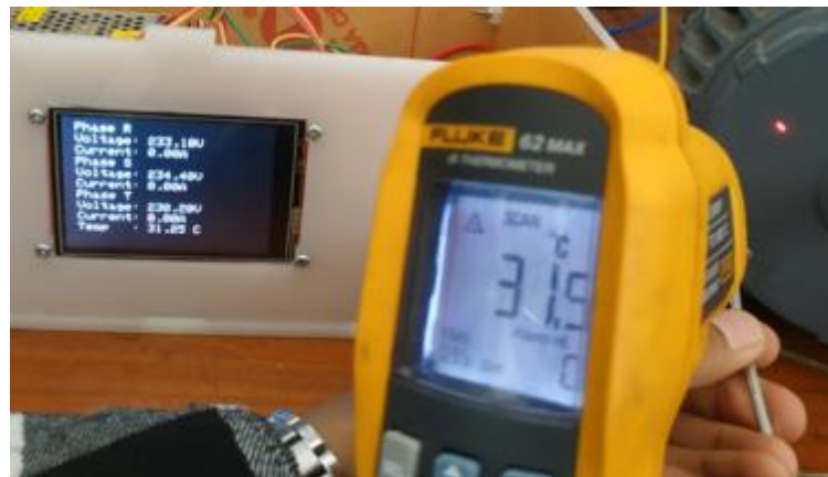
Gambar 5: Pengujian Sensor Suhu MAX6675 dengan Alat Ukur
