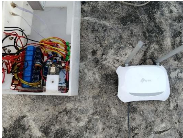
Gambar 7. Koneksi antar ESP8266 dengan Router
