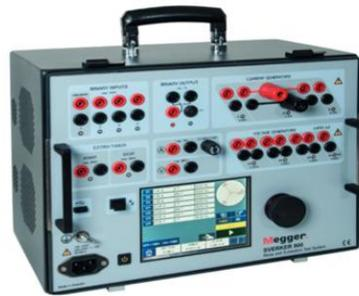
**Gambar 2. Current Injector yang digunakan untuk pengujian relai**
