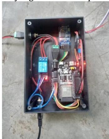
Gambar 9 Alat penyiraman tanaman cabai otomatis dan terjadwal
