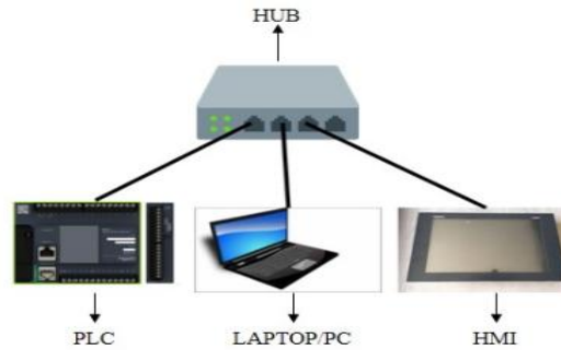
Gambar 4. Rancangan PLC dan monitoring
