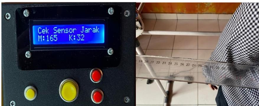
Gambar 8. Pengujian Sensor Ultrasonik Pengunjung Keluar
