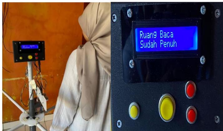
Gambar 10. (a) Pengujian Alat (b) Tampilan LCD ketika Ruang Penuh
