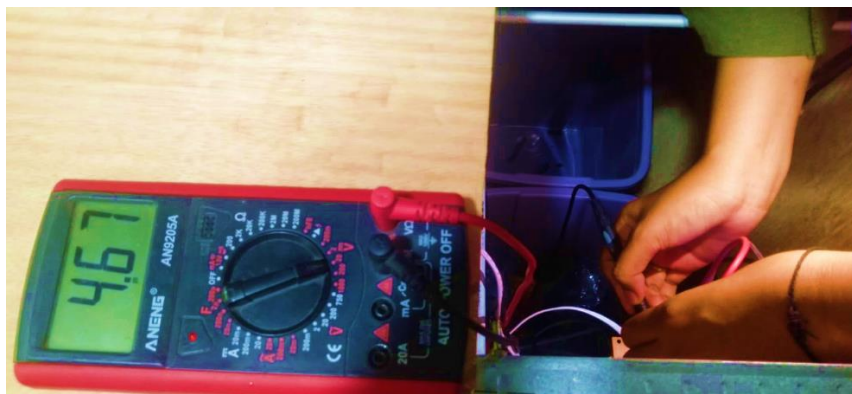
Gambar 7. Hasil pengukuran tegangan motor servo
