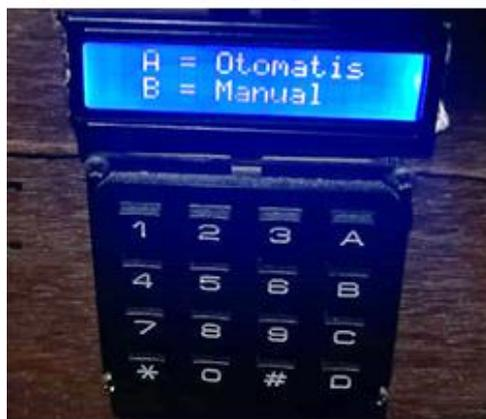
Gambar 9. Tampilan LCD Mode Otomatis atau Manual
